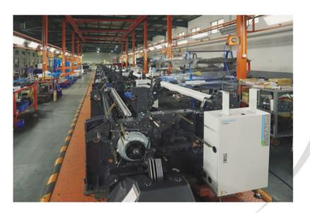
公司采用织机整机装配流水线,通过严格的质量管理、精细分化组装工序流程。用专用工具定扭矩紧固联结件,通过整条流水线上的技术来优化产品的质置控制,对生产设施的可靠性、成本效益和质量具有严格的要求,确保了整机组装的质量100%合格。
