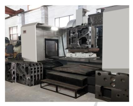
采用CNC加工中心成套加工关键零部件,使产品一次精加工完成,高精度的进口加工中心,成套加工左右墙扳,确保设备两侧齿轮同轴旋转,降低产品运转时产生的震动和噪音,提高织机稳定性及开机率。
